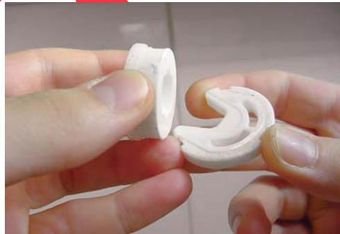
5 - Vérifiez l'état des disques et remplacez-les si nécessaire. Maniez-les avec précaution !
