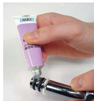
3 - Enduisez les joints de graisse au silicone, puis remontez.
