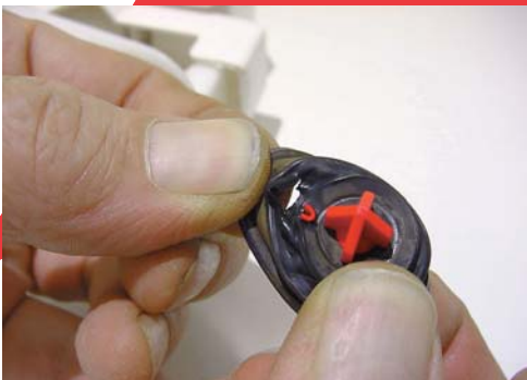
3 - La membrane est déchirée, remplacez-la.
